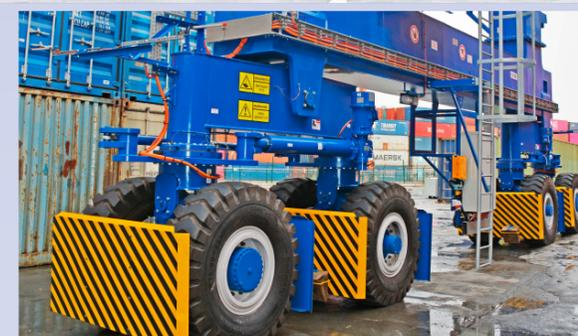
Конструкция крана для эксплуатации при низких температурах -40С. Ходовая часть адаптирована к работе на неровных поверхностях.
