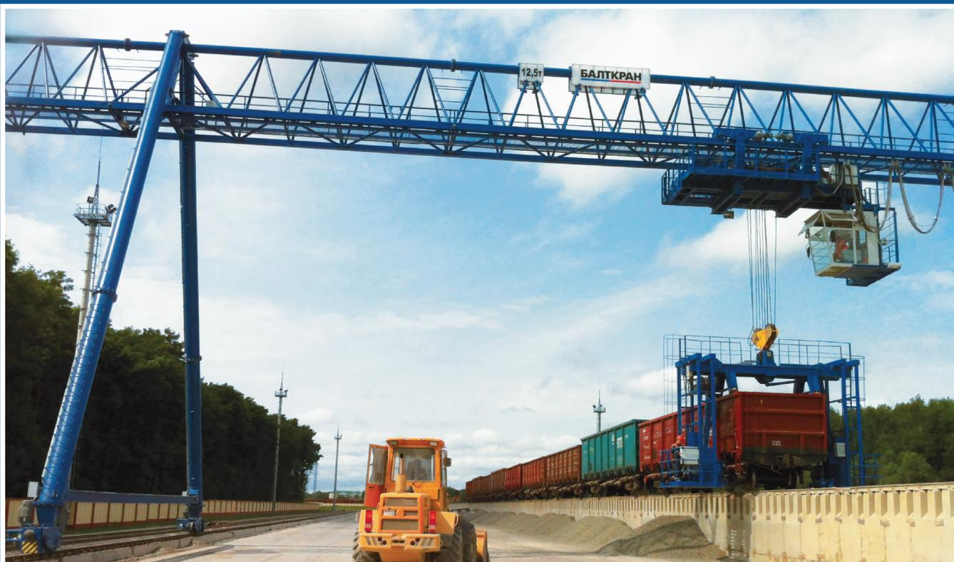
**КОЗЛОВОЙ КРАН** для механизированной разгрузки вагонов
