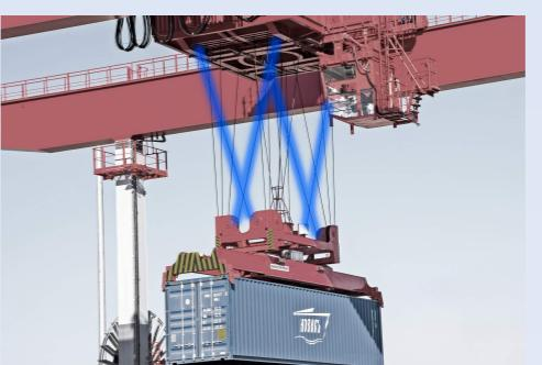
Система против раскачивания.
